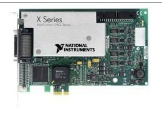
Рисунок 3. Многофункциональное PCI Express DAQ-устройство серии X
