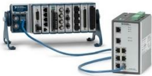
Рисунок 6. Благодаря поддержке длины сегмента 100 м и возможности использования существующей сетевой инфраструктуры, сбор данных с помощью Ethernet может расширить радиус действия вашей измерительной системы
