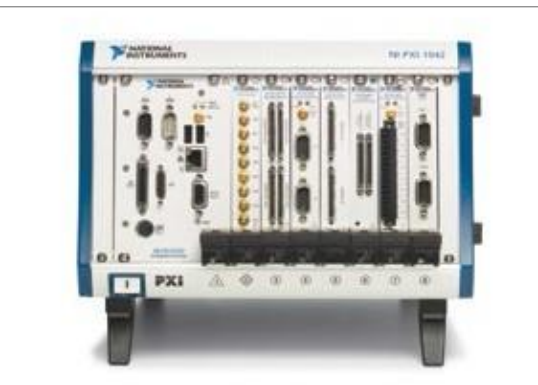
Рисунок 5. PXI платформа состоит из шасси, контроллеров и модулей ввода-вывода
