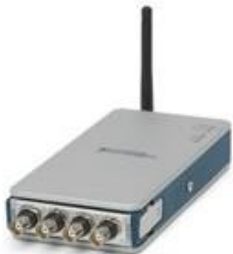
Рисунок 7. Для сбора данных через Wi-Fi применяются сети стандарта 802.11, чтобы отпала нужда в соединительных проводах между измерительной аппаратурой и управляющим компьютером
