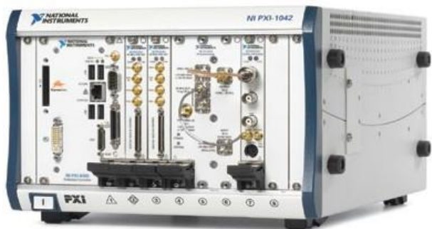
Рисунок 1. PXI система состоит из контроллера, шасси и до 17 модульных измерительных приборов
